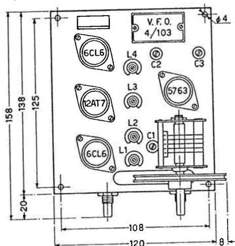
Dati d'ingombro e disposizione delle valvole, delle induttanze e delle viti di regolazione del Gruppo pilota N. 4/103/S.
